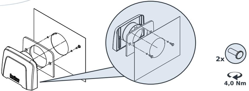
**2** Optional mit Seitenverkleidung/ optional with wall cladding
