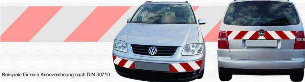
Beispiele für eine Kennzeichnung nach DIN 30710
